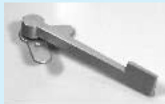
Sammensat CNC fræset emne i aluminium.
